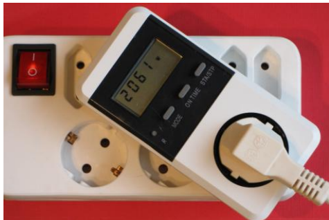
Strommessgerät im Einsatz
